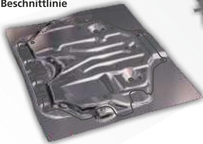
Gezogenes Bauteil mit Beschnittlinie
