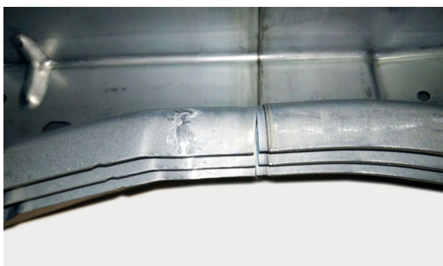
Im August 2021 traten bei der Produktion der Tailer Welded Blanks sporadisch Kantenrisse mit unterschiedlicher Länge auf. Ursache unbekannt
