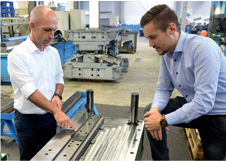
Häufig ist das Detail entscheidend: Die optimierte Beschneidkontur gewährleistet heute Kantenrissfreiheit bei der Produktion der Längsträger
