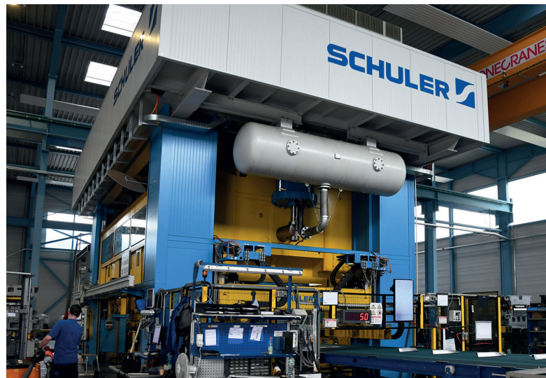
Auf einer Schuler-Pressen, die bei 1.600 t Presskraft und 7,3 m Tischlänge mit der Twinservo-Technologie arbeitet, werden die Längsträger für einen europäischen Hochvolumenhersteller gefertigt
