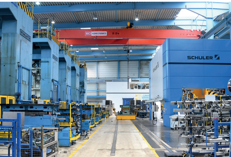
Für die Produktion von Zieh-, Press- und Stanzteilen stehen WMU Pressen mit Kräften bis 2.000 t und Tischgrößen bis 2,5 x 7,3 m zur Verfügung
