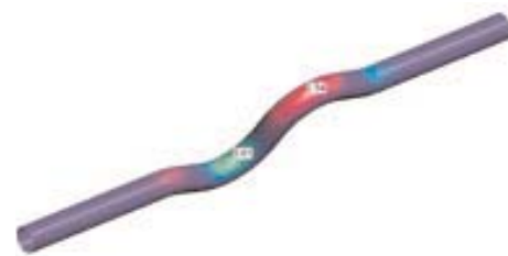
Nach der ersten Simulation mit dem Rundrohr zeigen sich kritische Mindestwandstärken.
