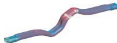
Nach dem IHU-Prozess sind die Wandstärken nun allesamt im unkritischen Bereich.
