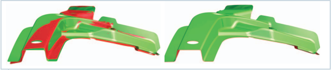
Eindeutig: Bauteilgeometrie (rot) und Referenzgeometrie (grün) vor (links) und nach der Rückfederungskompensation
